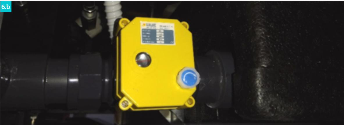
Bei Fahrzeugen mit elektrischem Entwässerungsventil, kann dieses im Fehlerfall auch manuell geöffnet werden. Hierzu ist der blaue Knopf herauszuziehen und in die entsprechende Richtung zu drehen.
