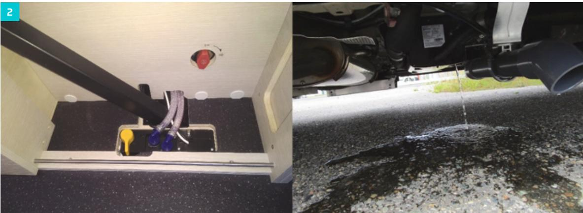
Drehen Sie den gelben Hebel am Wassererhitzer im Uhrzeigersinn, so dass das Wasser aus dem Boiler entweichen kann.
