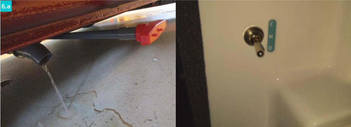
Öffnen Sie das Ventil des Abwassertanks am dafür vorgesehenen Drehhebel. Sollte Ihr Fahrzeug über ein elektrisches Entwässerungsventil verfügen, so stellen Sie den Schalter auf entleeren (discharge).
