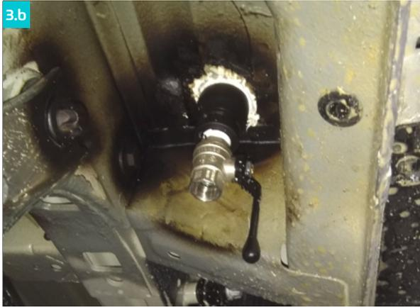
Das Aussenentwässerungsventil kann nur bei Temperaturen über 3° C genutzt werden. Wenn die Temperatur unter 3° C fällt, muss das Ventil in der geöffneten Position verbleiben und der Verschlussstopfen im Wasser Tank genutzt werden.
