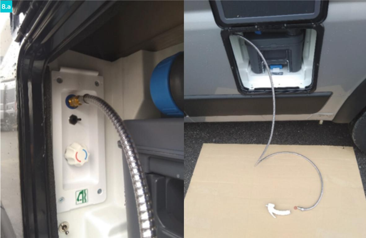
Verfügt Ihr Fahrzeug über eine Außendusche, so ist dieses System ebenfalls zu entleeren. Stellen Sie die Mischbatterie in die mittlere Position. Verbinden sie den Duschschauch mit der Schnellkupplung und demontieren Sie den Duschkopf.
