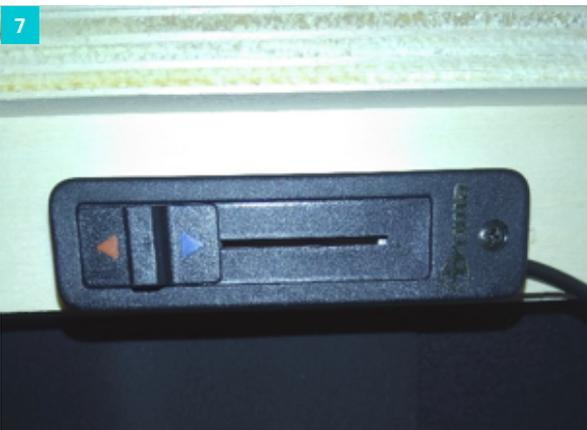
Stellen sie den Schieberegler für den Warmlufteinlass auf die rote (offen) Position. Sie finden diesen Regler unter der Batterie - Serviceklappe. Ist der Schieber in der roten Position, sowie die Webasto eingeschaltet, wird der Abwassertank ebenfalls beheizt.
