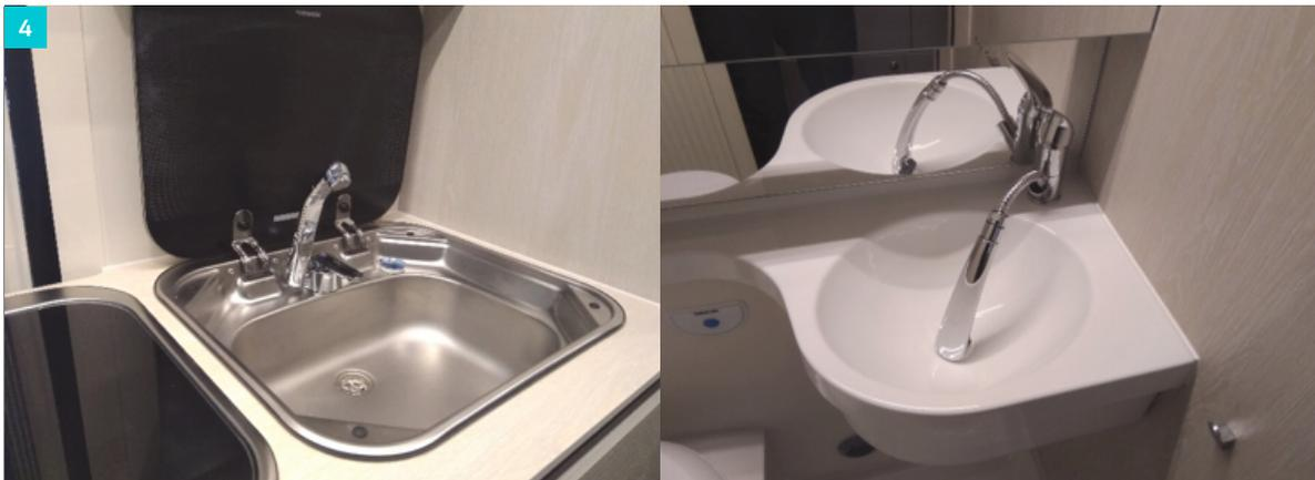
Sobald kein Wasser mehr aus dem Tank sowie Boiler fließt, starten sie die Wasserpumpe und **lassen sie die beiden Wasserhähne in der mittleren Position geöffnet**. Um sicherzustellen das sich kein Wasser mehr in den Leitungen befindet schalten Sie die Wasser Pumpe am Control Panel aus und blasen Sie 10 Sekunden mit Ihrem Mund Luft in die Wasserhähne.
