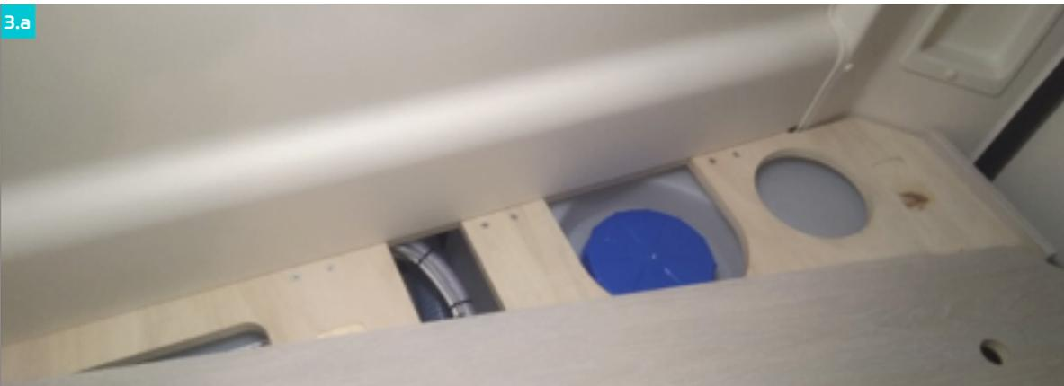
Entfernen Sie die Holzabdeckung über dem Frischwassertank auf der hinteren rechten Seite. Öffnen Sie den Wassertank (blauer Deckel) und entfernen Sie den Verschlussstopfen innerhalb des Tanks. Sollte ihr Tourne über ein Aussenentwässerungsventil verfügen, so ist diese ebenfalls zu öffnen.
